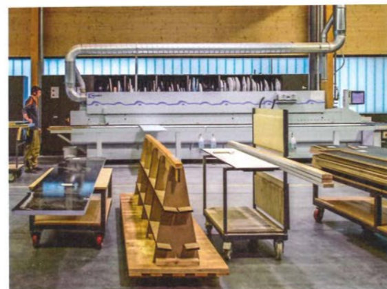
Die Kantenleimmaschine im Einmannbetrieb: Auf dem Wagen geht es dann weiter zur CNC
