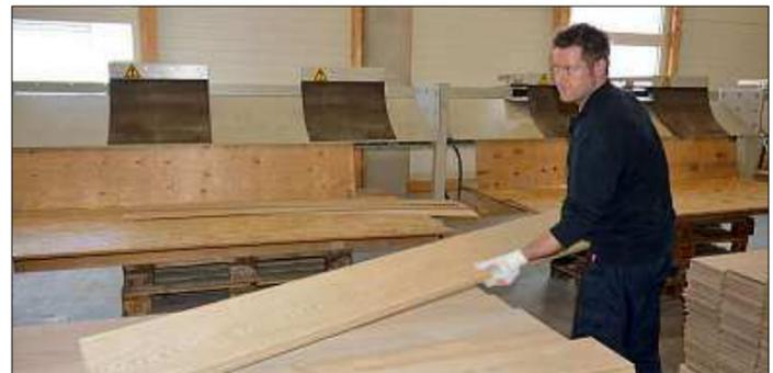
**Trotz des Einsatzes computergesteuerter** Verarbeitungsmaschinen gibt es im Herstellungsprozess der Bodendielen bei Hain an den Nahtstellen der einzelnen Verarbeitungsschritte stets noch eine zusätzliche Kontrolle durch Fachleute.
