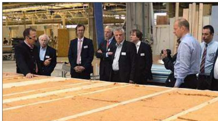
**Zur Isolation setzt** Regnauer in den vorgefertigten Wänden aus Holzrahmen und Gipsplatten passgenau zugeschnittene Zellstoffmatten ein. Sie versprechen nicht nur Formstabilität auf Jahrzehnte, sondern auch ein gesundes Wohnklima.
